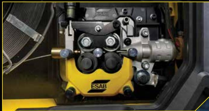
4-valjkasti sistem pogona i brzina dovoda žice od 20,3 m/min za pozitivne performanse dovoda žice sa svim prečnicima žice.
