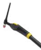
Exor TIG gorionici SR 18 Radni ciklus: (AC) 100% pri 225 A | (DC) 100% pri 320 A Prečnik elektrode: 0,5–4,0 mm Način hlađenja: Tečno (vodeno)
