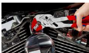
"Klešta-ključ" sa ravnim čeljustima 250mm
