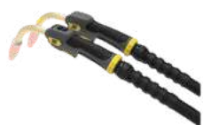
Exor MIG 4.06² gorionici – gasno hlađeni, standardni i CX Radni ciklus: 60% pri 420 A Prečnik žice: 0,8–1,6 mm (0,035–1/16 in.) Način hlađenja: Vazdušno
