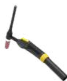
Exor TIG gorionici SR 21 Radni ciklus: (AC) 100% pri 240 A | (DC) 100% pri 240 A Prečnik elektrode: 0,5–3,2 mm Način hlađenja: Tečno (vodeno)
