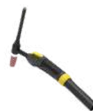
Exor TIG gorionici SR 17 Radni ciklus: (AC) 35% pri 120 A | (DC) 35% pri 170 A Prečnik elektrode: 0,5–2,4 mm Način hlađenja: Gasno (vazdušno)
