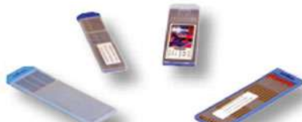
Volfram elektrode (zelene (100 % W), sive (2 % Ce), rumene (1,5 % La) ...)
