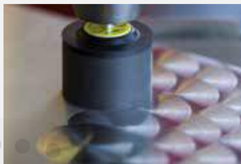
Primer ukrasnog brušenja sa R-Flex telom za mermerisanje SFM 656 na limu od nerđajućeg čelika
